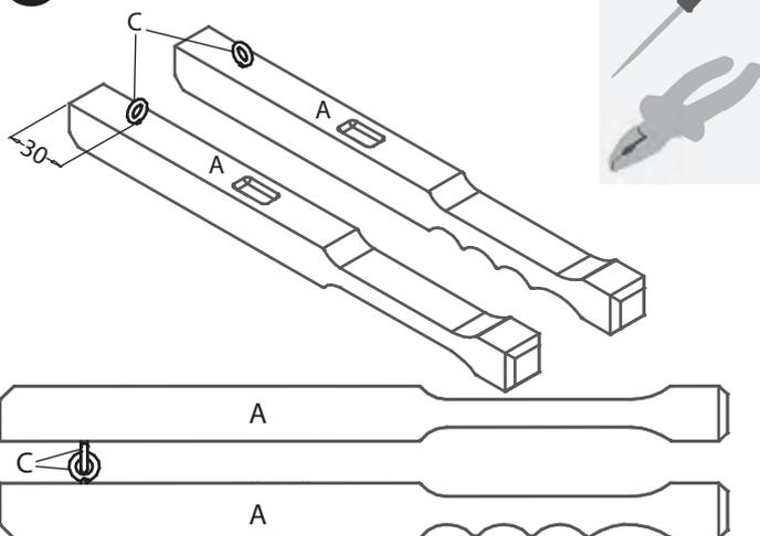
Die Position der Ringschraube **mit einem Vorstecher** vorstechen und dann die Ringschraube jeweils soweit in das Holz schrauben, bis der Ring am Holz anliegt - eine **Ringschraube muss in Längsrichtung** und eine in **Querrichtung** gedreht sein.
