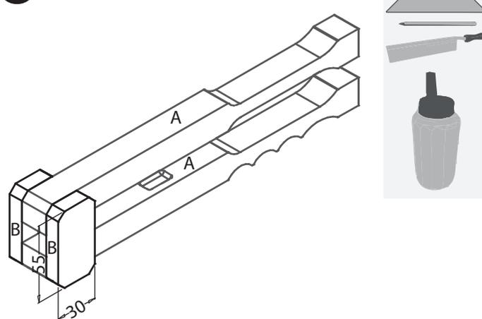
Auf die **Holzleiste (B) (120 / 30 / 10 mm)** die beiden seitlichen Leisten mit einer Länge von je **55 mm** aufzeichnen und aussägen. Die beiden Teile werden **nur auf die UNTERE Griffleiste aufgeleimt!** Zum Schluss den Nussknacker **mit Schleifpapier nachbearbeiten**. Um die **Oberfläche** deines Nussknackers zu schützen, streichst du ihn am besten mit **Öl oder Wachs** ein.
