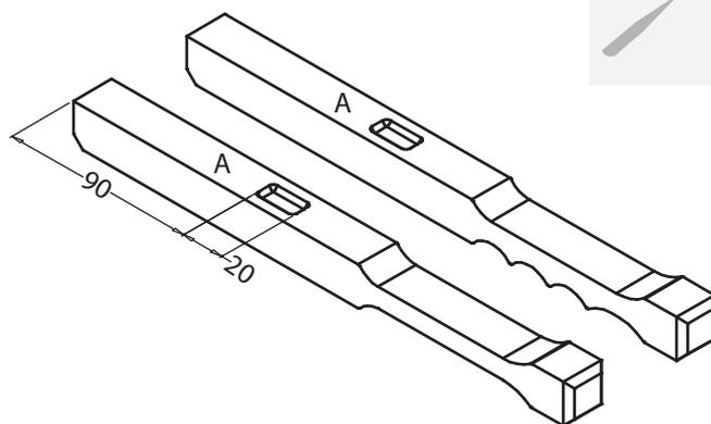
Auf die beiden **Holzleisten (A) (260 / 20 / 20 mm)** die Formen der Griffleisten (Plan 1) aufzeichnen und mit der **Feile/Raspel** (oder Laubsäge) ausarbeiten. Anschließend mit einem **runden Schnitzmesser** eine **Vertiefung mit ca. 3 mm Tiefe** an der dargestellten Position ausnehmen.
